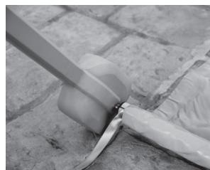
2. Inserire il perno avvolgitore fino in fondo (a destra o a sinistra della copertura).
