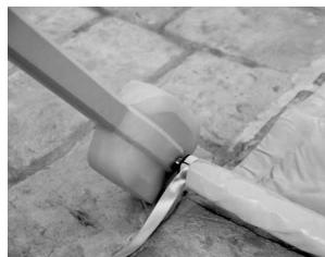
2. Insérer le carré d'enroulement jusqu'en butée (à droite ou à gauche de la couverture).
